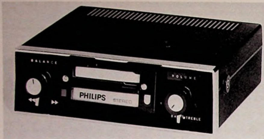
Bild 8. Ansicht des neuen Autoradios „Coupé IAC 860“ von Philips mit 6-Sender-Speicher für UKW-Stereo-, MW- und LW-Empfang. Es ist mit einem Stereo-Cassettenspieler, elektronischer UKW-Entstörschaltung und modernster IC-Technik ausgestattet. Das Gerät ist mit 135 mm Einbautiefe das gegenwärtig kleinste Cassetten-Autoradio der Welt mit Senderspeicher
