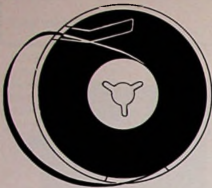
Bild 2. Prinzip der Einloch-Endlos-Cassette, z. B. des Stereo-8-Systems
